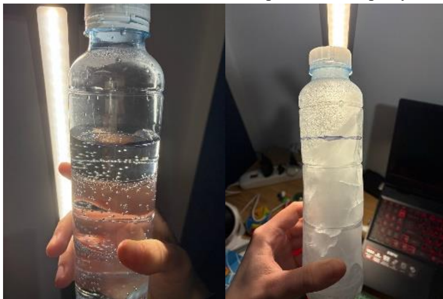
Рис.1 Ліворуч – Рівень води в пляшці до заморозки, праворуч – Рівень води після заморозки
